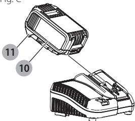
2. Insérer le bloc-piles **10** dans le chargeur, en vous assurant qu'il y est correctement calé. Le voyant rouge (charge) clignotera de façon continue indiquant que le cycle de chargement a commencé.
