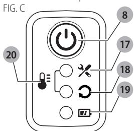
Cuando está encendida la LED de estado de carga de la batería **19**, sin tener en cuenta el color, la herramienta está ENCENDIDA.
