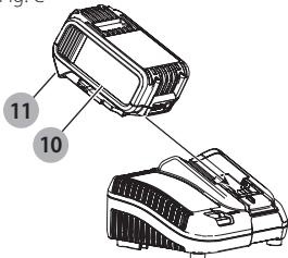
2. Inserte la batería **10** en el cargador, comprobando esté bien fija. La luz roja (de carga) parpadeará continuamente para indicar que se ha iniciado el proceso de carga.
